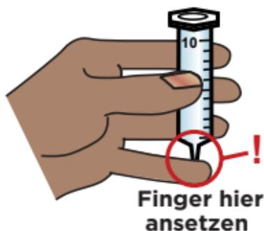
**2. Untere Spritzenöffnung mit dem Finger abdecken und 10 mL Testflüssigkeit einfüllen**
