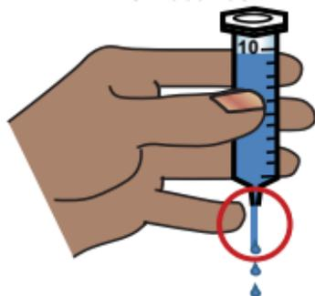
**4. Nach 10 Sekunden untere Spritzenöffnung wieder mit dem Finger verschließen**
